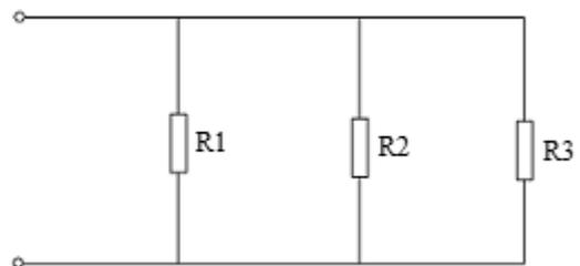
Dados  $R_1=10\Omega$ ,  $R_2=15\Omega$  e  $R_3=6\Omega$ .
